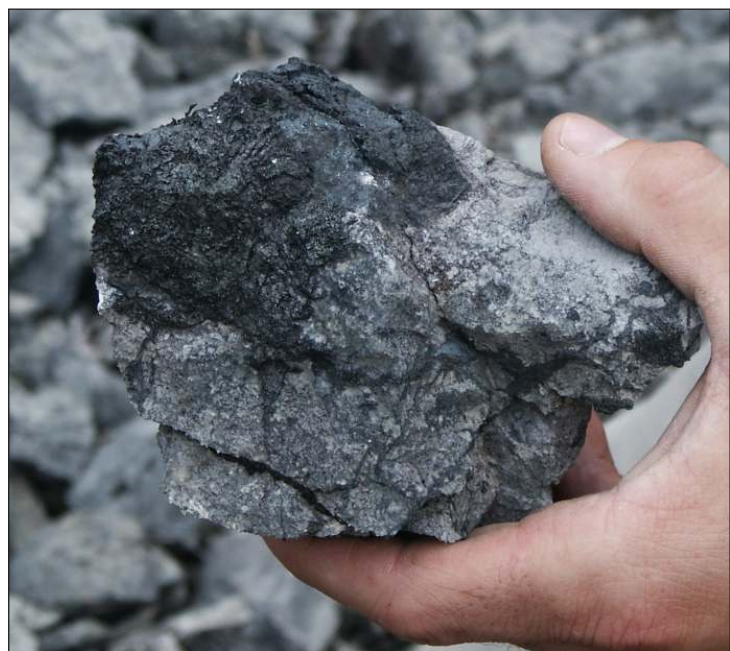
Minéralisation caractéristique de pyrolusite, qui remplit des cavités et des vacuoles dans le calcaire algair de la formation Gays River, à la mine abandonnée de Glebe, dans le Sud-Est du Nouveau-Brunswick.
