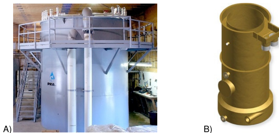
Figure 18: Biofiltre à sable à lit fluidisé classique de courant ascendant (A) - PRAqua Ltd et biofiltre à sable à lit fluidisé avec une structure annulaire d'entrée (B) - Marine Biotech Inc.)
